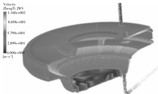
图5 平压管方案计算域内部流动速度矢量图
