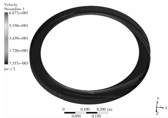
图9 法兰盘间隙绕流流态
